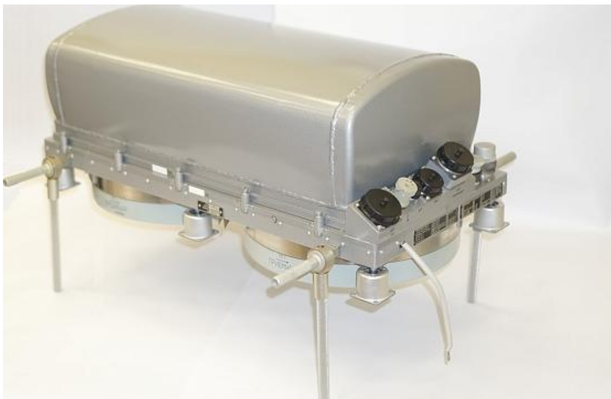
Рисунок 1.8 — Доплеровский измеритель скорости и угла сноса
