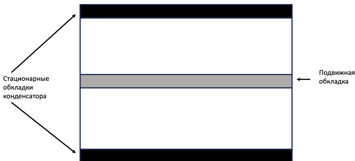
Рисунок 2.4 – Упрощенная схема емкостного акселерометра
