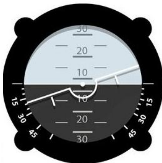
Рисунок 1.9 — Авиагоризонт с индикацией «вид с земли»
