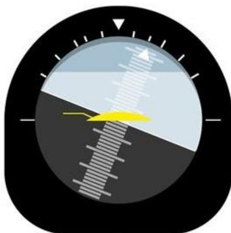
Рисунок 2.0 — Авиагоризонт с индикацией «вид с самолета»
