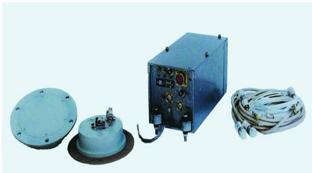
Рисунок 3.6 — Комплект оборудования радиовысотомера больших высот А - 072
